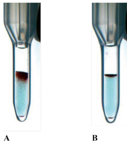
Figuur 2. MF-reactie afgelezen door IH1000 met DiaMed bloedgroepenkaartje. A toont de MF-reactie veroorzaakt in de anti-A kolom door een mogelijk technisch probleem en B zoals deze te zien is wanneer het gaat om een kloon erythrocyten die het A-antigeen niet hebben.
